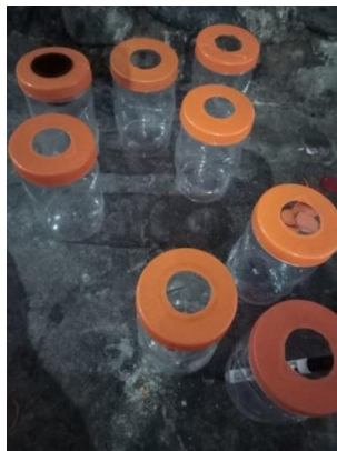
Gambar 5. Proses Pelubangan dan Pengecatan wadah hidroponik
