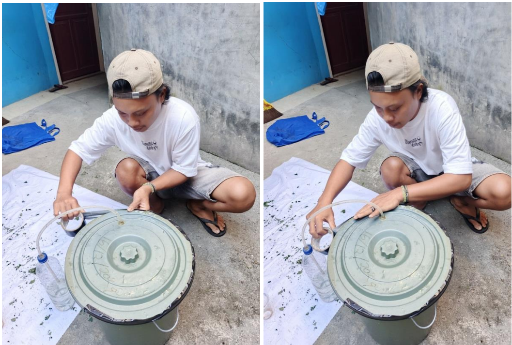
Gambar 8. Proses pemasangan lakban dan penyambungan selang ke ember
